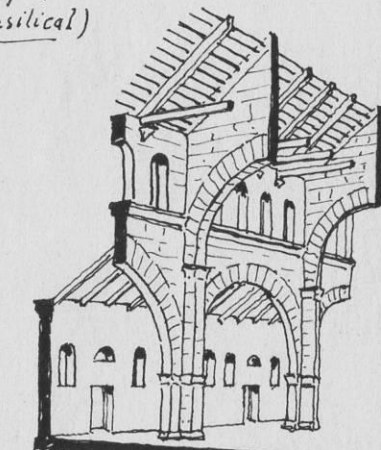
Comble bois sur vaisseau cloisonné sur arcades (ici les diaphragmes dépassant la toiture) (Rouïha - Syrie du Nord) Fermes sur corbeaux IX e -s.
