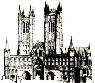
Lincoln, cathédrale. Vue sur la façade occidentale, plaquée, en forme d'écran décoratif, devant l'ancienne façade romane (1225-1255).
