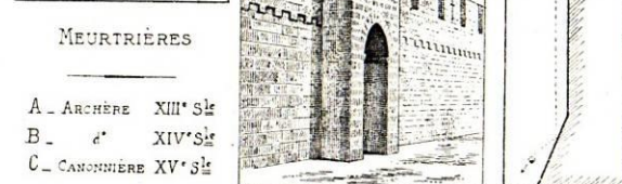
MEURTRIÈRES A - ARCHÈRE XIII e S è B - " XIV e S è C - CANONNIÈRE XV e S è Fig. 5/1003 Mâchicoulis XIV e S è (AVIGNON Remonté) Coupe de Mâchicoulis Profil à Ricochet
